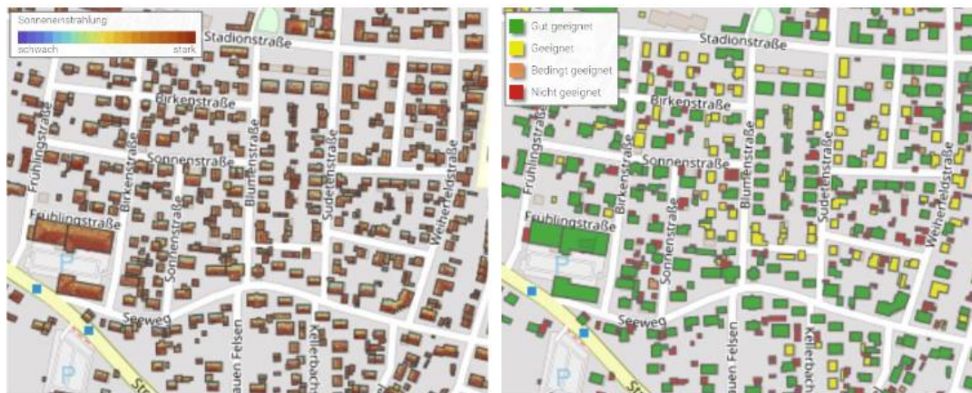
Abbildung 22: simulierte solare Einstrahlung (links) und Eignung der Dachflächen für PV-Anlagen (rechts) 1
